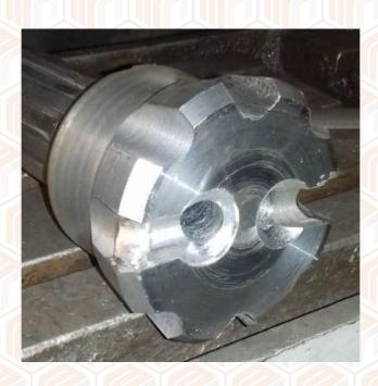
Сечение и форма системы продувочных каналов и пазов для удаления бурового шлама рассчитаны так, что обеспечивают оптимальную производительность при бурении.
