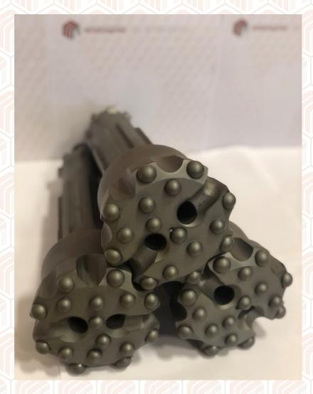
Коронка буровая изготавливается в зависимости от требований заказчика с плоской или с вогнутой, или с выпуклой фронтальной рабочей поверхностью, оснащенная твердосплавными вставками «зубками» с головкой (сферической, баллистическая), изготовленными лучшими мировыми производителями. КБПИ предназначена для работы в тяжелых условиях, то есть для разбуривания скальных и рудных твердых и абразивных пород таких как: гранит, твердый известняк, базальт и т.п.
